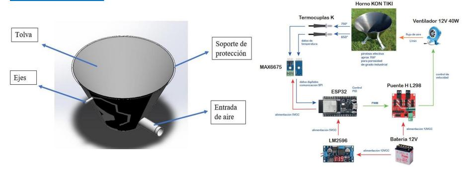
Para resolver este problema es necesario diseñar y simular un control automático del aire para el horno Kon-Tiki. Un protocolo de aprendizaje automático fija la temperatura objetivo y la aireación por etapa, y un control PID modula el ventilador para mantenerlas. El operador supervisa y ajusta desde el programa. Con ello se reduce la variabilidad entre lotes y se logra biochar consistente desde residuos agrícolas.
